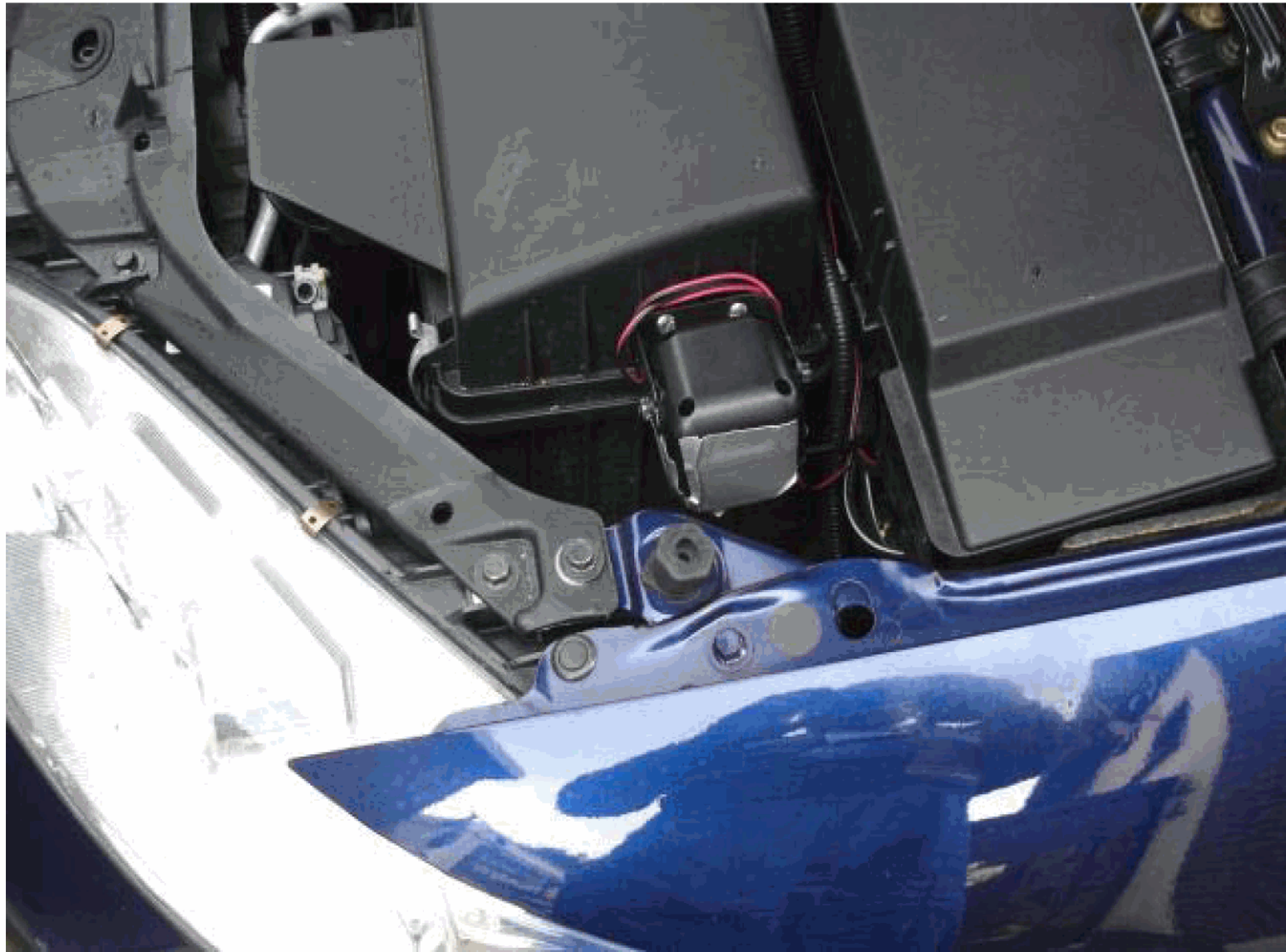
Ansicht Lautsprecher im Motorraum. LS nach unten gerichtet und mit Gewebeklebeband abgeklebt. (war mir pers. sonst zu laut)
